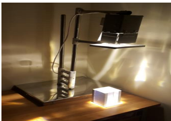
شکل ۴: شبیه ساز خورشید برای یک سلول فتولتاییک
