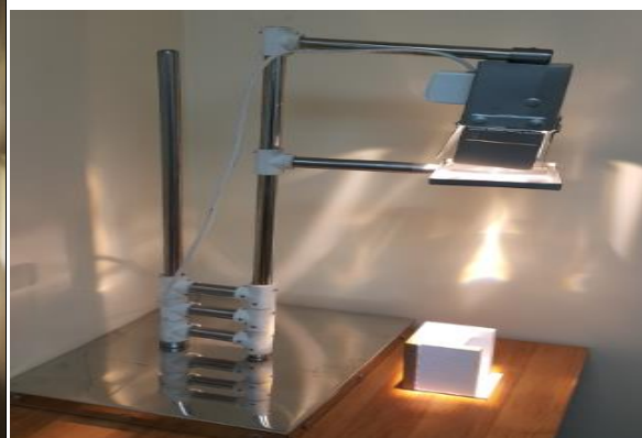
شکل ۴: شبیه ساز خورشید برای یک سلول فتولتاییک
