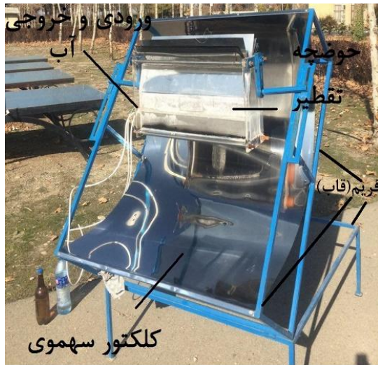
شکل ۱- آب‌شیرین‌کن ساخته‌شده و اجزاء آن
